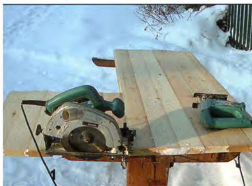
Чтобы быстро выкроить из самодельного щита заготовку для столешницы, воспользовались электролобзиком и дисковой пилой.
