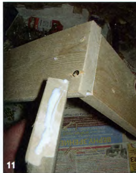
11 Из выкроенных в размер стенок собрали каркасы выдвижных ящиков на клею и саморезах.
