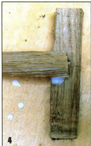
4 Крылья собрал на водостойком клее ПВА.
