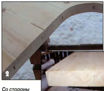
Со стороны торцов досок остались зазоры в соединениях щита между пазами и шипами. Их заделали клинышками, вставленными на клею ПВА.
