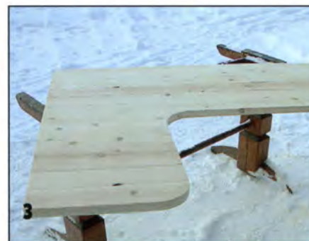
Кромки распилов аккуратно выровняли шлифованием.
