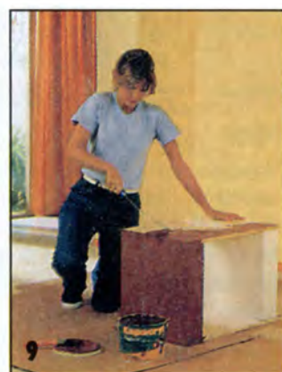
Собранные модули покрывают водорастворимым акриловым лаком.
