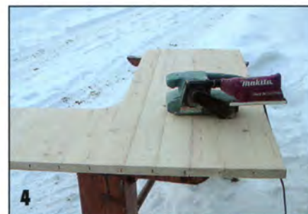
Воспользовавшись ленточной шлифовальной машинкой, обработали столешницу с обеих сторон.
