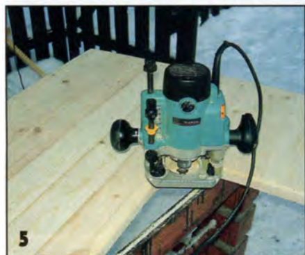
Кромки столешницы скруглили фрезой с направляющим подшипником.
