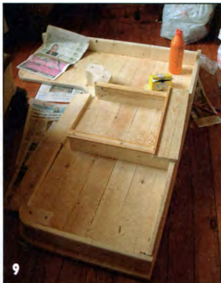
9 Собрав нижний «венец» столешницы, прикрепили несущие доски с направляющими для ящиков.
