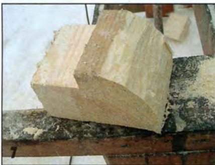
7 Вырезать из цельных заготовок угловые вставки нужной формы было несложно.
