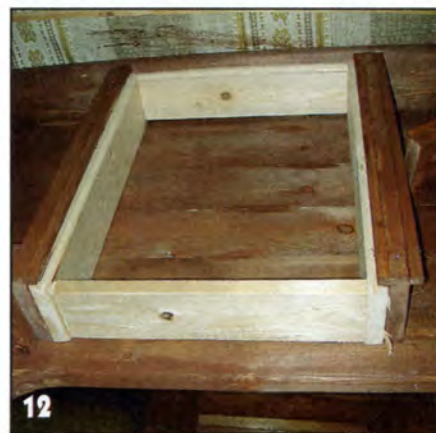
Сразу после сборки каркасы установили на их штатное место под столешницей и зафиксировали клинышками, чтобы при высыхании клея их не повело.
