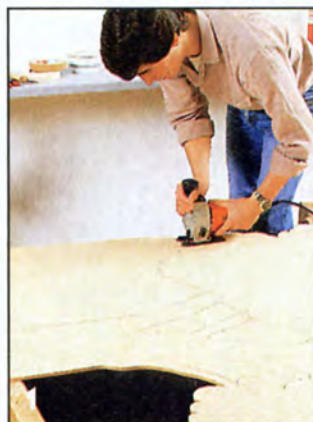
Контуры «дерева» по разметке выпиливают электролобзиком.
