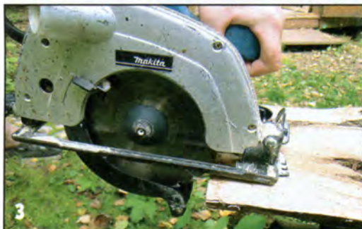
3 Из дубовой доски выкроил заготовки для крыльев ветряка.
