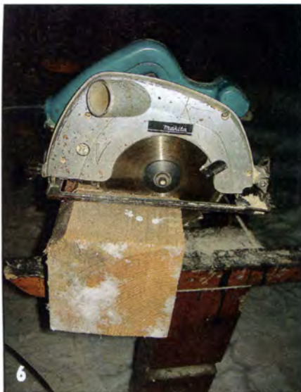
6 От бруса отрезали точно в размер две заготовки для угловых вставок.
