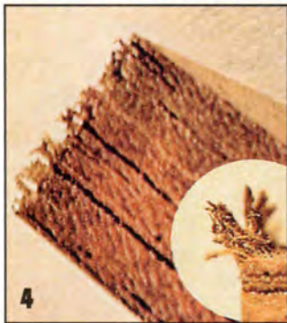
И на хорошем приспособлении с упором на краю торца обрабатываемой заготовки могут образоваться маленькие сколы и «бахрома».
